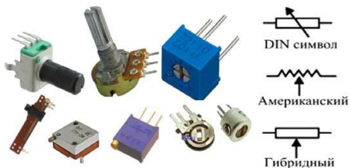
Рис. 10. Переменные резисторы (потенциометры)
